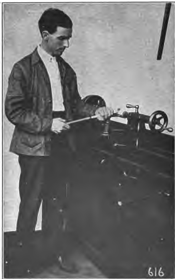
Fig. 27. Using Skew Chisel.
